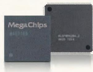
(System on Chip) ASICをお客様に提案しています。また、世界中のファウンドリから低消費電力に特化した製造プロセスを選定するとともに、低消費電力IPの開発を進めています。
